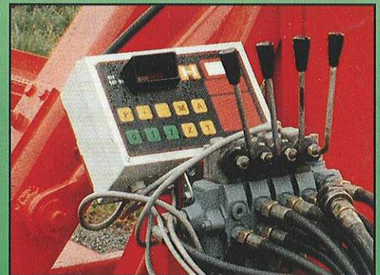
boîtier de commande électrique avec contrôle électronique
